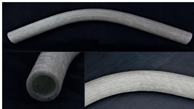
Bild 2. Mittels lokalem Streckbiegen umgeformtes Hohlprofil © Fraunhofer ICT
